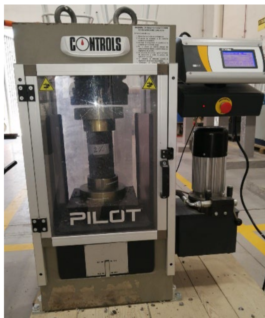
Figura 2. Prueba de resistencia a la compresión de especímenes de concreto permeable con adición de fibras de acero.
