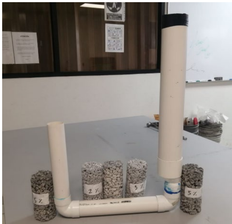
Figura 4. Permeámetro de carga constante para la obtención del coeficiente de permeabilidad en especímenes de concreto permeable con adición de fibras de acero.
