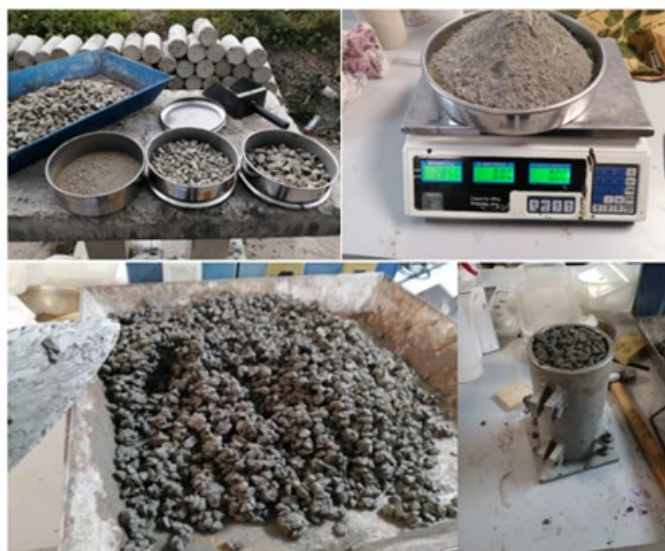
Figura 1. Diseño y fabricación de especímenes de concreto permeable con adición de fibras de acero.
